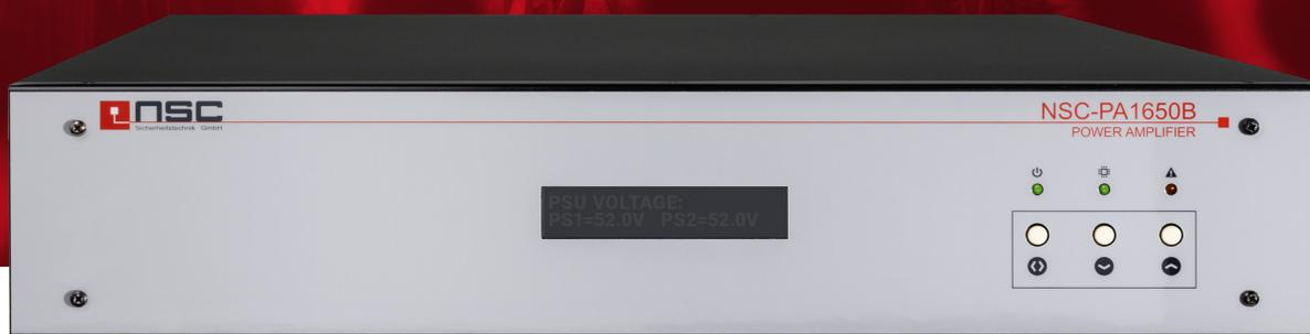
Die volldigitalen Class-D Verstärker aus der NSC-PA Reihe, wurden bei der Entwicklung optimal auf das MULTIVES System abgestimmt und sind nach DIN EN 54-16 zertifiziert. Die Endstufen sind 2 Höheneinheiten hoch und für den Einbau in ein 19"-Rack vorgesehen. Sie werden mit 48V-Gleichspannung mit Hilfe des NSC-PSM48-Netzteiltes versorgt. Das Stromversorgungs- und Back-Up-System ist für eine Versorgungsspannung von 230 VAC ausgelegt und zertifiziert nach EN 54-4.
